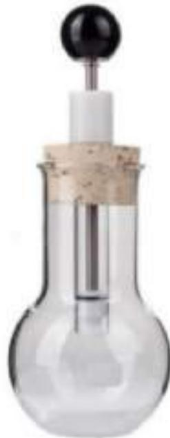
Figura 36. Pipeta Hensel-Stempel para toma de submuestras de zooplancton.
