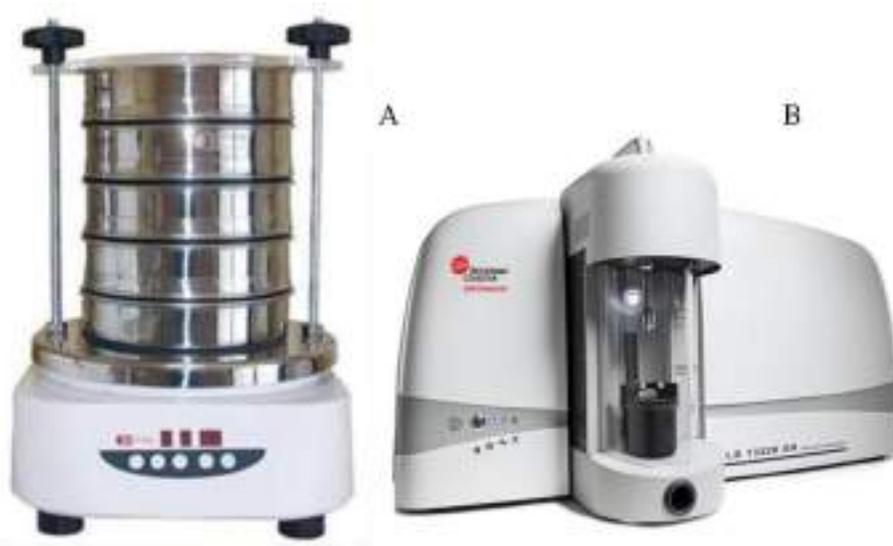
Figura 23. (A). Vibrador de tamices (“sieve shaker”), (B) “Coulter counter” para la separación de las fracciones del sedimento.
