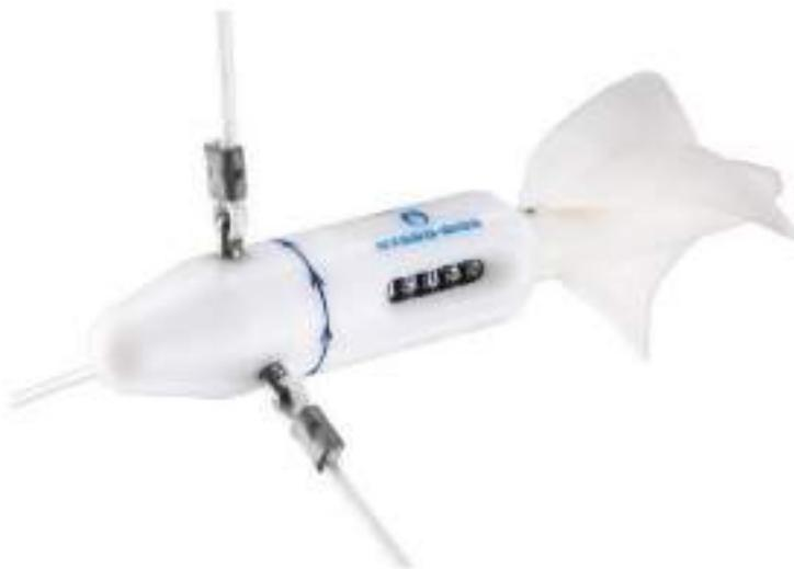
Figura 37. Flujómetro para determinación de volumen de agua filtrada por la red.
