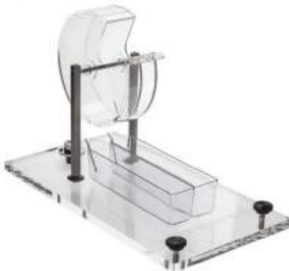
Figura 34. Submuestreador de Folsom, para separar la muestra de zooplancton en fracciones iguales.
